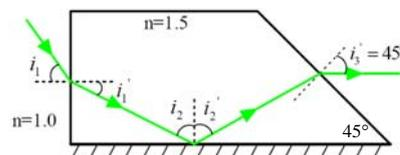
图1-5 光线在玻璃块中的折射和反射
