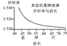
图1-6 光的色散、典型玻璃的色散曲线
