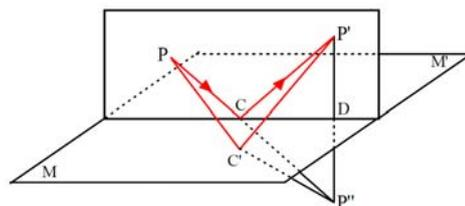
图1-11 遵守反射定律的光线
