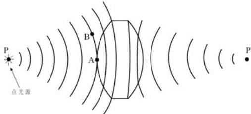
图1-7 透镜对波面的作用与透镜成像
