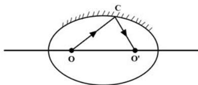
图1-12 回转椭球面凹面反射镜
