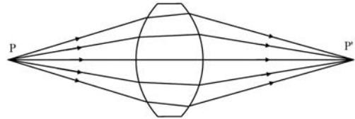
图1-8 透镜对光线的作用与透镜成像
