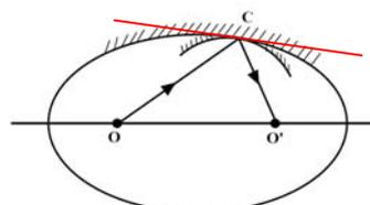
图1-13 内切于回转椭球面的凹面反射镜
