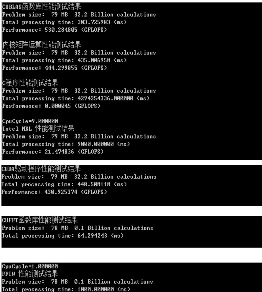
图 2-7 大数据量矩阵乘法性能测试结果
