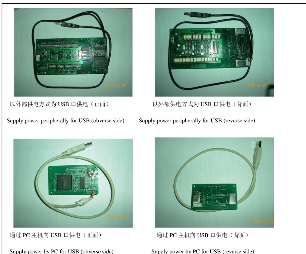
图 7-10 基于 CYPRESS EZ-USB FX2<sup>TM</sup> 芯片的 PCB 板
