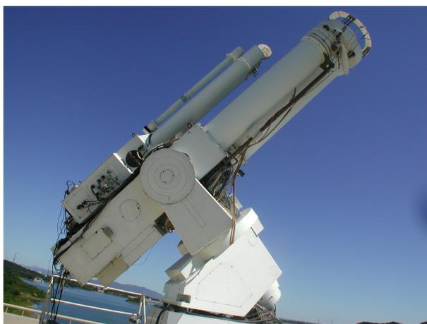
图 1.24: 多通道太阳磁场望远镜
