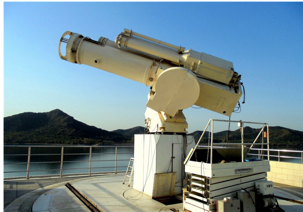
图 4.2 35 厘米太阳磁场望远镜
