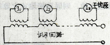
图9 电磁耦合形式干扰
