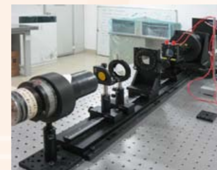
光学实验室偏振分析器 Mueller 矩阵测试系统
