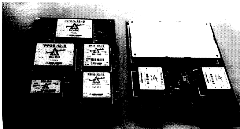
图 5-14 DC-DC 变换模块构成的多路电源板
