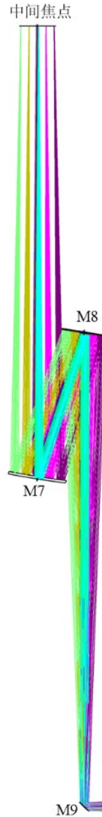
图 2-8 AIMS 准直系统光学设计示意图
