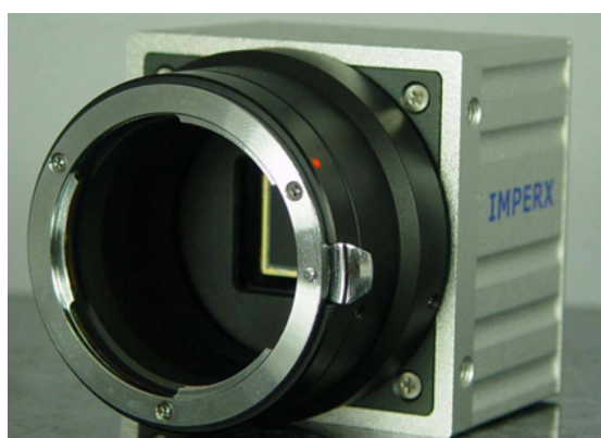
图 3.4 IPX-1M48-L CCD实物图。
